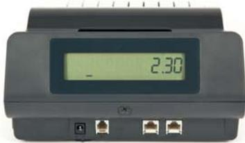
Die Rückansicht der ER-230 mit den Schnittstellen für Netzanschluss, Schublade und den beiden seriellen Schnittstellen
